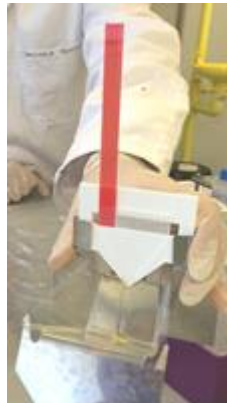
Figura 17: Colocação das palhinhas em suporte para entrada de ar.
